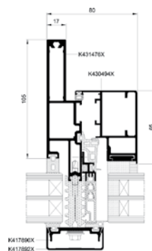
rez stĺpom s oknom MB-SR50N IW – štandardná verzia
